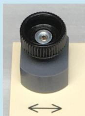
Einige Anwender berichteten, dass Ihnen das Ausrichten am besten gelang, indem Sie bei Gantry 180 Grad das Lichtfeld des Linacs einschalteten und mit einem Auge durch die Blende parallaxefrei schauten.
