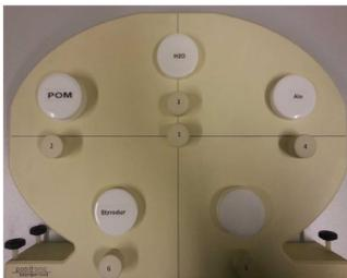
Abbildung 2: Phantom Bodyshape mit Dichteinserten
